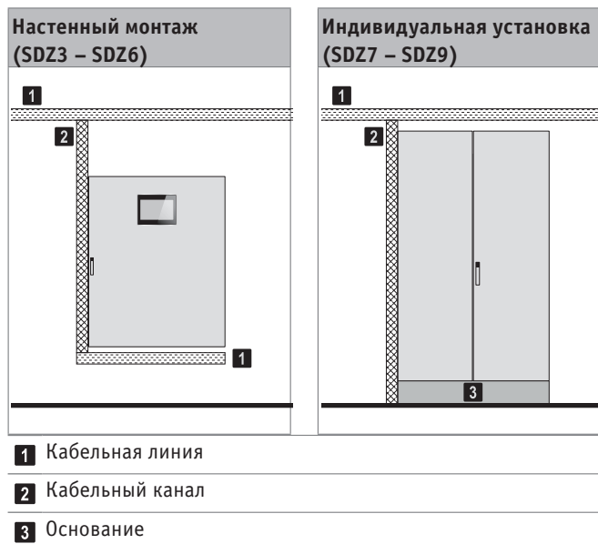
Рис. 7: Конструкция панели зонального управления
