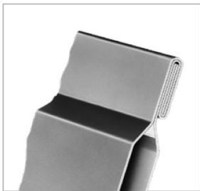
Рис. Е3: фальцевые соединения делают пакет теплообменника особенно прочным, благодаря этому со стороны входа и выхода толщина материала многократно увеличивается.
