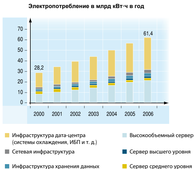
Рис. 5.1 Электропотребление по типу оборудования
