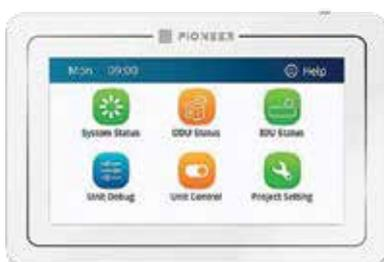
Портативный отладчик – это переносное устройство, которое сочетает в себе широкий функционал, аналогичный программному обеспечению для отладки, современный красочный сенсорный дисплей и простоту применения (не требует сложного монтажа и подключения дополнительных устройств).
