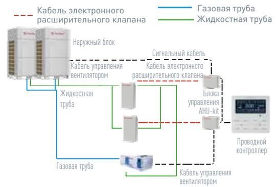
АНУ-KIT подключенный к одному внешнему блоку параллельно
