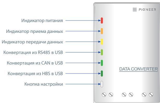
USB-конвертер предназначен для преобразования протокола CAN/HBS/RS485 в USB для передачи данных между компьютером и системой кондиционирования.
