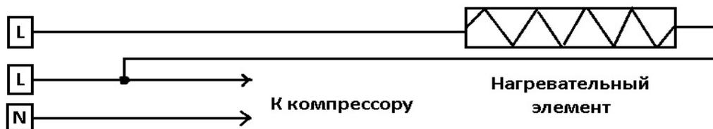
Схема подключения нагревательных элементов для случаев, когда реле (пускатель) компрессора находится в наружном блоке.
