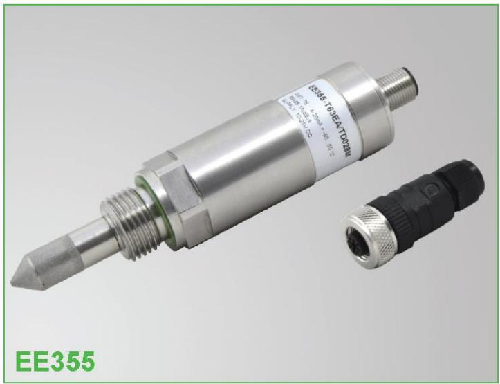
Компактный датчик точки росы EE355 с диапазоном измерений до  $-60^{\circ}\text{C Td}$  идеально подойдет для использования в системах со сжатым воздухом, сушильнях для пластика и в промышленных процессах сушки. Встроенный функционал автоматической калибровки обеспечивает погрешность измерений  $<2^{\circ}\text{C Td}$ .
