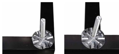
6) Прикрепите резьбовые трубчатые опоры между двумя опорными профилями с помощью самонарезных винтов, предусмотренных в комплекте (используйте продолговатые отверстия и отверстия на резьбовых трубчатых опорах) посредством специальной отвертки.
